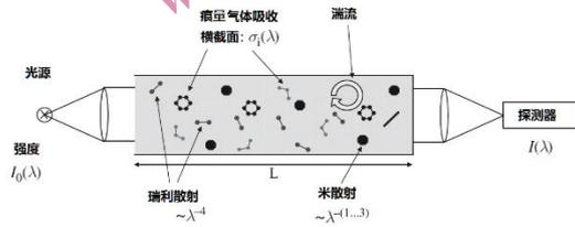
图 1. DOAS 方法原理及影响要素示意图 (Platt&Stutz, 2008)
