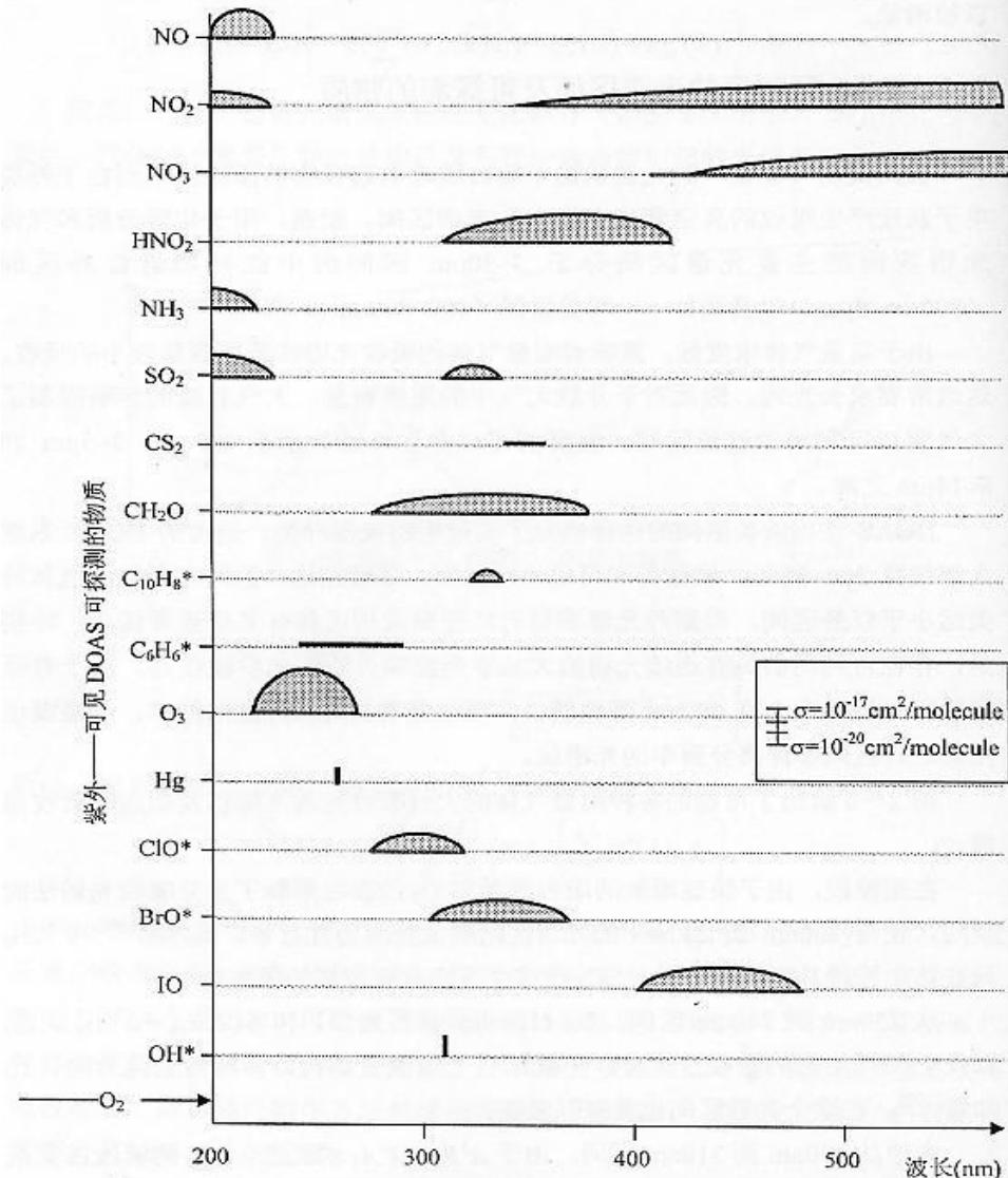
图 2-6 大气痕量气体探测可使用的紫外——可见波长区间一览表。纵坐标：分子吸收截面 ( $10^{-20} \sim 10^{-17} \text{ cm}^2/\text{molecule}$ , 见插图)。分子在大气压力下表现出强转动结构用星号 (\*) 表示。
